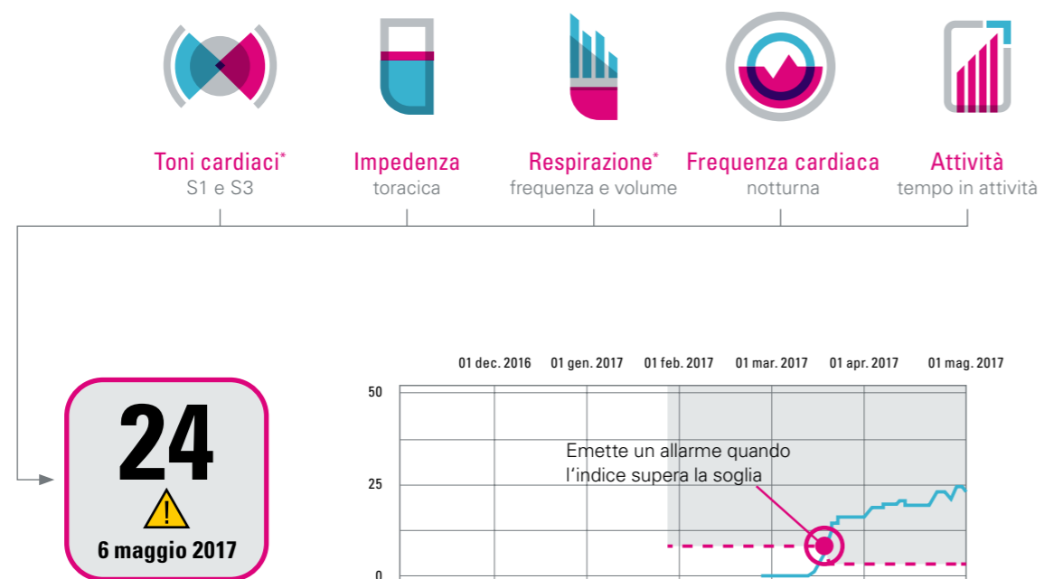
Indicatore composito ad alte prestazioni utilizzato per rilevare il peggioramento dell'insufficienza cardiaca utilizzando più misurazioni fisiologiche
